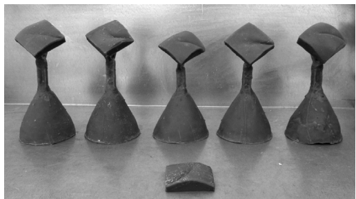
Fig. 2 - Realización de las ceras para fundición Figs. 3a y 3b - Montaje de los árboles de colada
